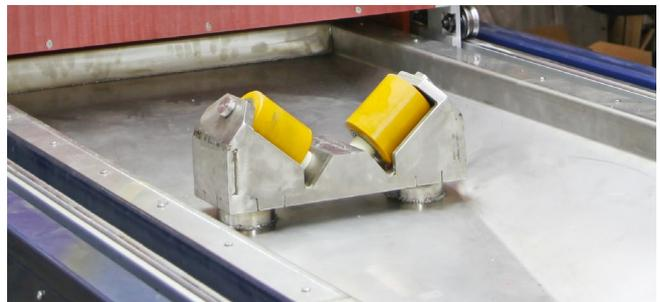
*Опорное подъемно-опускное устройство с роликами для позиционирования детали*
