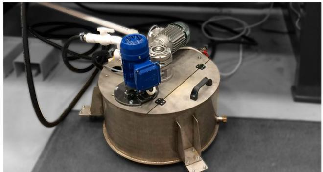
*Подвижный суспензионный бак на роликах*
