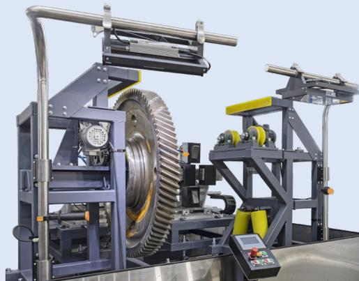
Электромагниты комбинированного намагничивания левого поста контроля первого рабочего места
