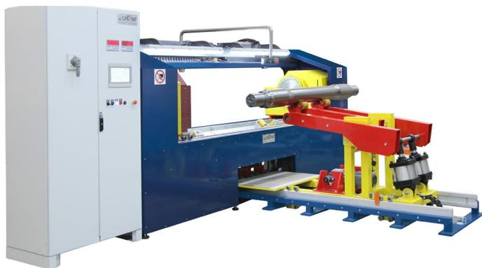
*ErMag 3000 AC/DC — с устройством фронтальной автоматической погрузки осей*
