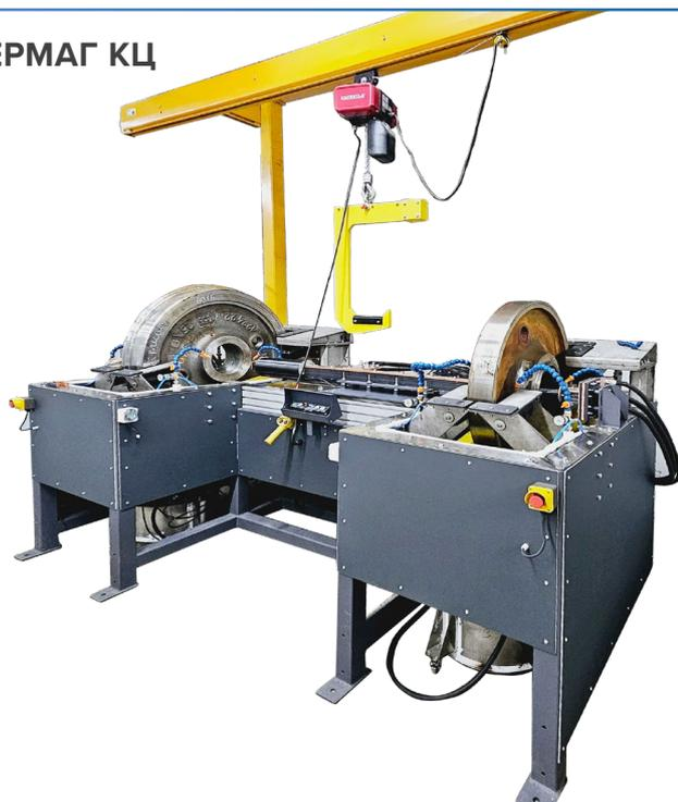
Дефектоскоп **ЕрМаг КЦ** обеспечивает выявление поверхностных и подповерхностных дефектов любой ориентации в соответствии с ГОСТ Р 56512-2015, ГОСТ Р ИСО 9934-2011, ГОСТ Р ИСО 9931-2-2011, ГОСТ 53700-2009 на поверхности катания, боковой поверхности, ступице и внутренней поверхности колесного центра; в зоне прилегающей к прижимному бурту бандажа и поверхности центрального отверстия ходового колеса.
