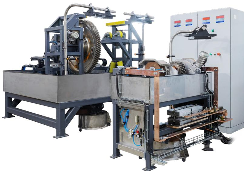
Дефектоскоп **ErMag КЗШ/М** обеспечивает выявление поверхностных и подповерхностных дефектов любой ориентации в соответствии с ГОСТ Р 56512-2015, ГОСТ Р ИСО 9934-2011, ГОСТ Р ИСО 9931-2-2011 на активной поверхности зубьев и впадин.
