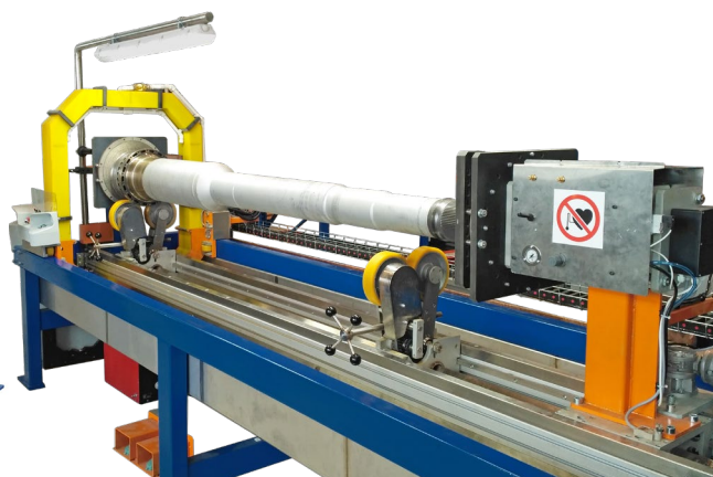
ЕрМаг 3000 — контроль вала, размещенного на люнетах
