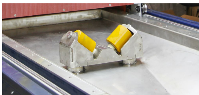
Опорное подъемно-опускное устройство с роликами для позиционирования детали
