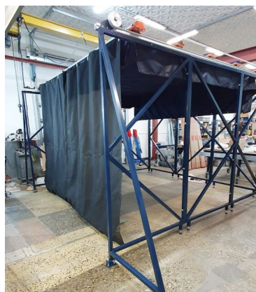
Кабина затемнения с механизированным перемещением затемняющего тента
