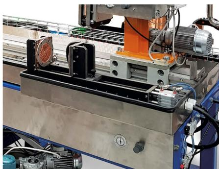
**Второе рабочее место — дефектоскоп для циркулярного намагничивания малогабаритных деталей (длина до 400 мм) на раме основного**
