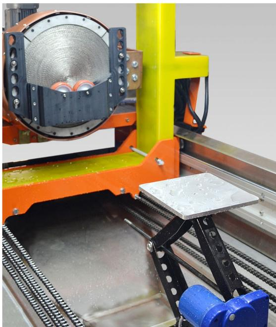
**Роликовые опоры, крепящиеся на бабки, и подъемно-опускной ложемент с электроприводом**
