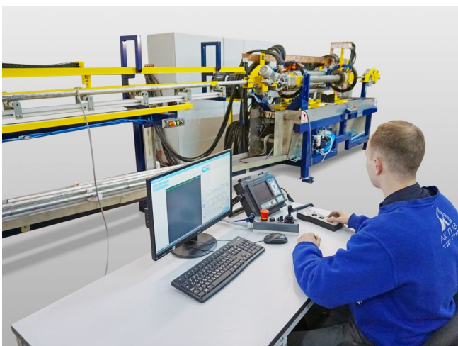
ErMag 2500 с рабочим местом дефектоскописта при осмотре внутренней поверхности вала
