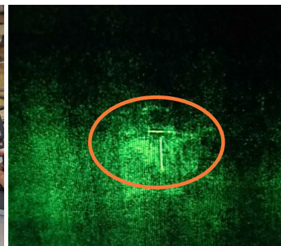
Выявленные с помощью видеозондоскопа индикации искусственных дефектов на внутренней поверхности вала
