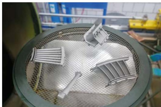
Установки KAMA: поворотный стол. Зона загрузки / выгрузки деталей
