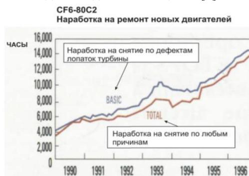
Рис. 1 – Средняя наработка новых двигателей CF6-80C2 на снятие с крыла по дефектам лопаток турбины и по всем иным дефектам, вместе взятым
