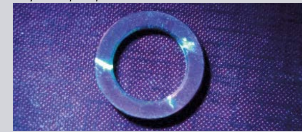
Шайба. Сквозные радиальные трещины
