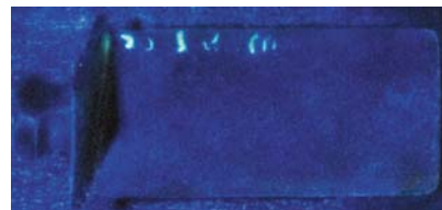
Лопатка из титанового сплава с множественными линейными индикациями дефектов типа трещин
