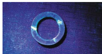
Шайба. Сквозные радиальные трещины
