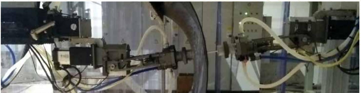
Система с мостовой конструкцией с двумя манипуляторами
