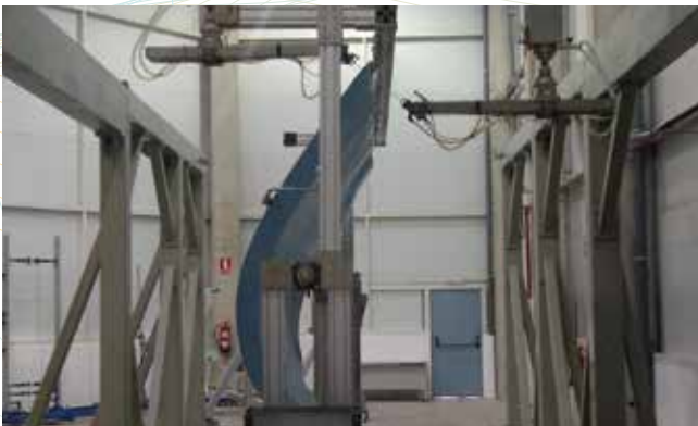
Подвижная мостовая конструкция сканера
