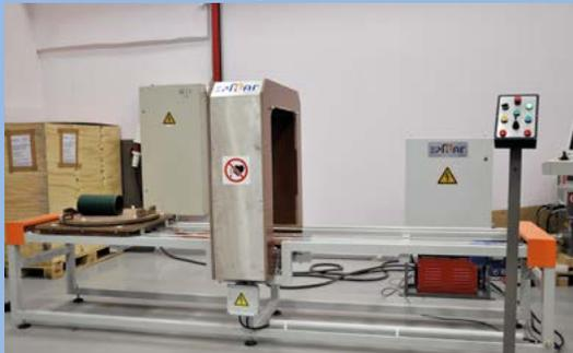
Полуавтоматические установки для размагничивания деталей в условиях производства, ремонта и эксплуатации
