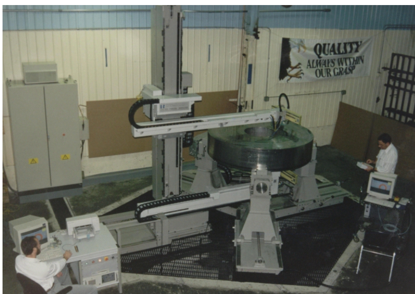
LFS-300 система контроля кованных колец.
