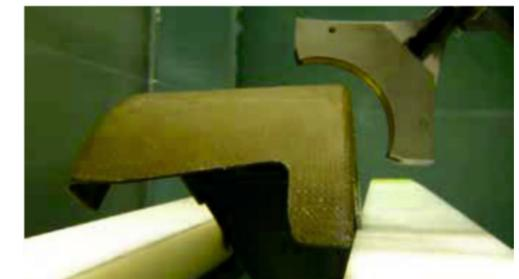
Специальный датчик для контроля криволинейных участков деталей (например, авиационных)
