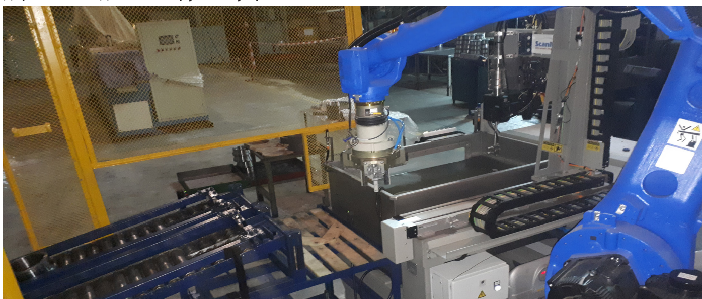
Устройство вращения прутков с держателем датчиков (ручное управление)
