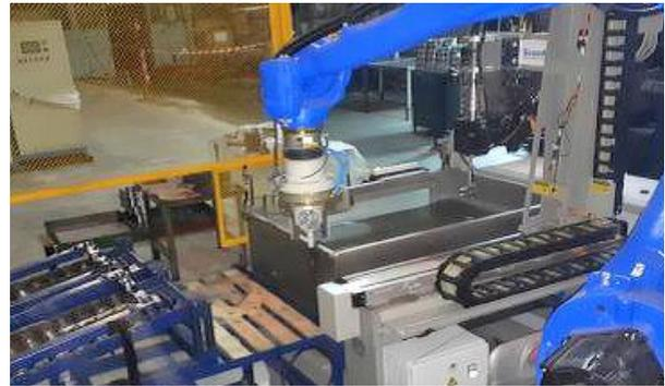
Робот для автоматической загрузки/выгрузки деталей в конфигурации LS-50 TT
