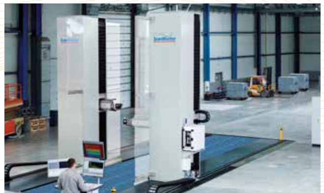
Система с двумя отдельными башнями
