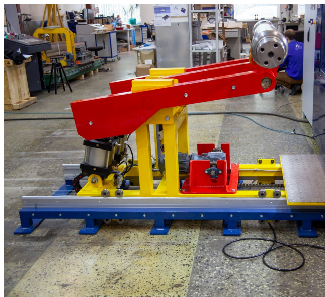
Устройство автоматической фронтальной погрузки/разгрузки
