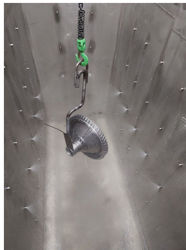
Промывка диска душированием без форсунок на линии МОККИ-2000
