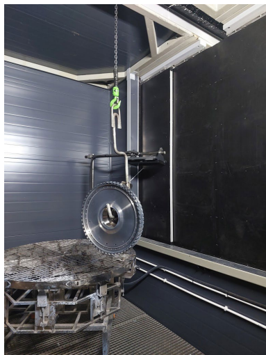
Контроль диска ГТД в универсальной камере линии МОККИ-2000
