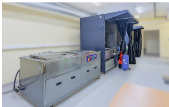
Линия с УЗ-мойкой и ванной сушки до 120 °C
