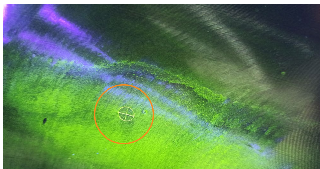
Пример выявления стандартного дефекта на внутренней поверхности настроечного образца
