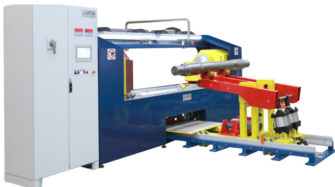
ErMag 3000 АС/DC — с устройством фронтальной автоматической погрузки осей
